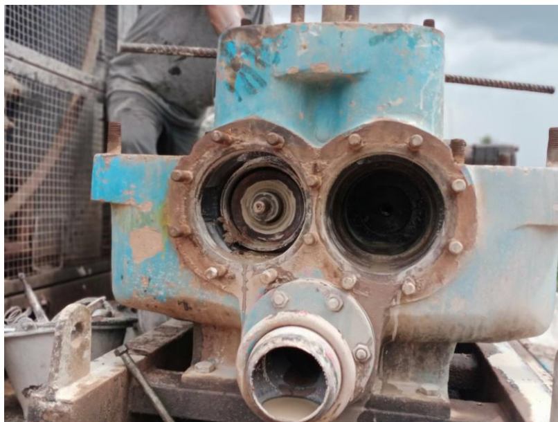
รูปที่ ๗ แสดง งานล้างทำความสะอาดปั้มน้ำโคลน
